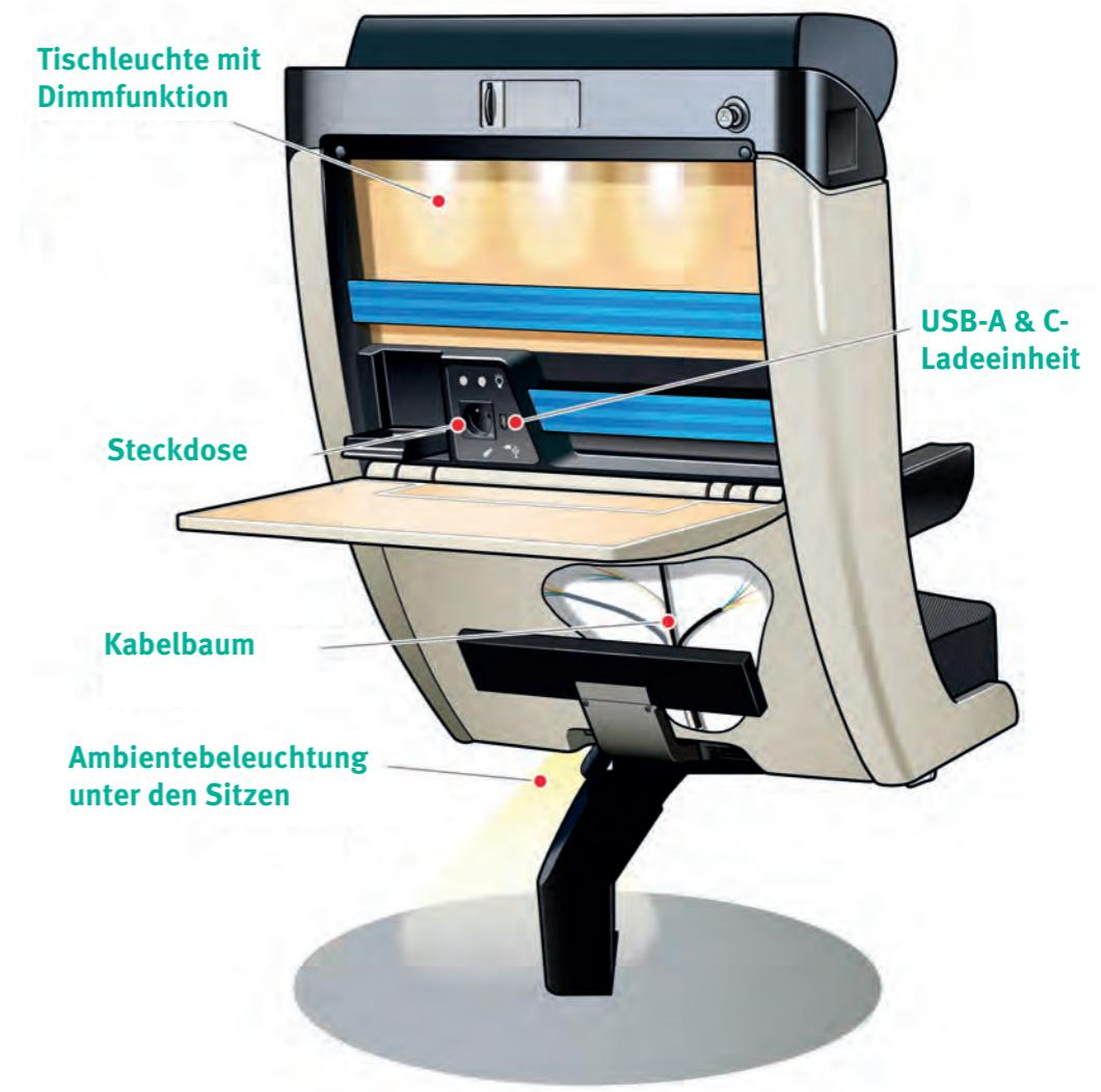
Komplette Sitzelektronik und Beleuchtungslösungen für Schienenfahrzeuge
